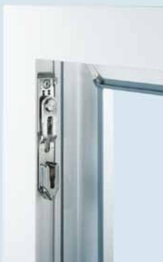
**Wir sparen nicht an Details**, damit Ihre Kunden Energie sparen können. Zum Beispiel mit der Sommer-/Winterlüftung durch die Energiesparschere. Die geringe Öffnungsweite des Flügels sorgt in der Winterlüftungsstellung für eine Reduzierung der Energiekosten. Die Nachrüstung an bereits eingebauten Fenstern mit SIEGENIA-AUBI Fensterbeschlägen ist ohne großen Aufwand möglich.
