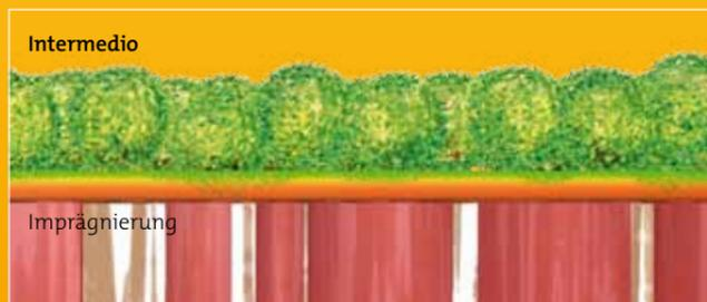
Die ADLER HighRes® Zwischenbeschichtung erzeugt einen kompakten, durchgehenden Film, der das Holz gleichzeitig wasserundurchlässig und atmungsaktiv macht.
