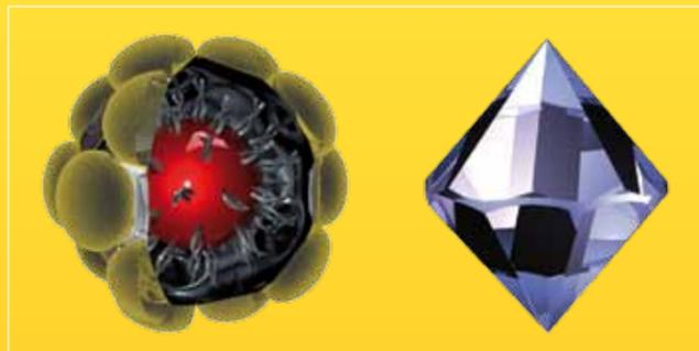
Das Polymer des ADLER HighRes® Decklacks hat einen harten Kern und eine weiche Hülle und garantiert so optimale Elastizität und Widerstandsfähigkeit bei einem stark erhöhten Verankerungspotential.
